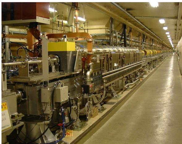
図 18: KEBB ライナック陽電子生成装置
