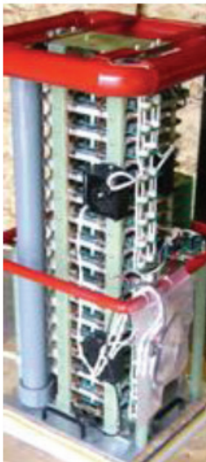
Fig. 67 半導体スイッチの例。文献[30]より引用。
