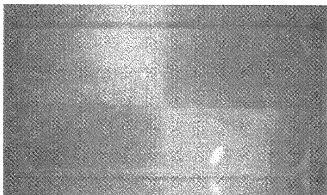
図36. TiNをコーティングしたサファイアの高周波窓の発光。手前の面は左上1/4が、又、向こう側の面は右上1/4がコーティングしていない場所。コーティング部分ではほとんど発光しない。
