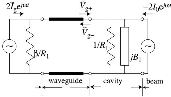
図 5.4 図 5.3 でトランス昇圧比を導波管固有アドミッタンスへ繰り込んだ場合。
