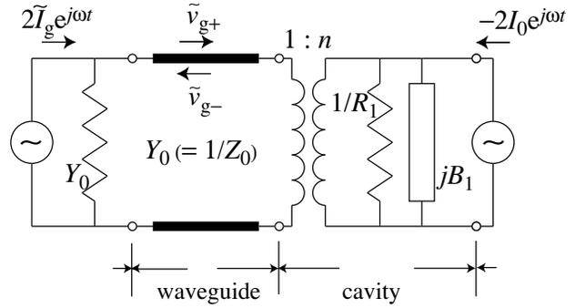
図 5.3 外部ビームおよび外部電源で基本加速モードが励振される空洞の等価回路。電流、電圧の時間変化は  $e^{j\omega t}$  に従う。
