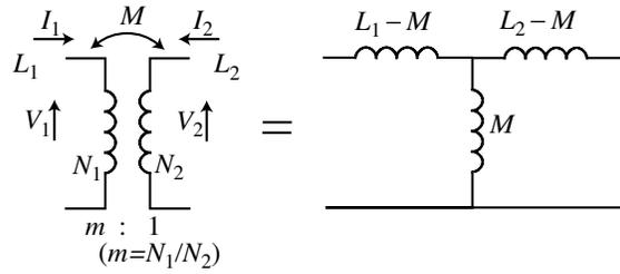
図 4.4 損失のないトランスの等価回路
