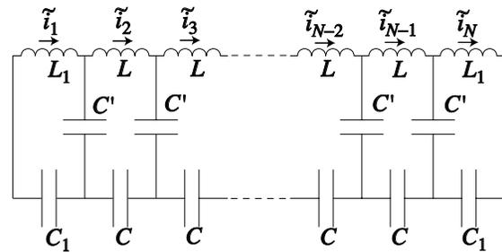
図 3.11  $N$  セル構造の等価回路
