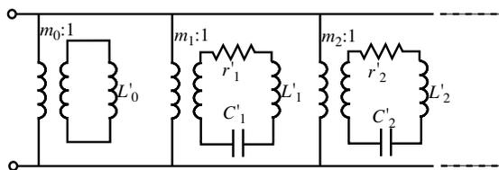
図 4.6 結合の大きさを理想トランスの巻線比で表したときの空洞の等価回路
