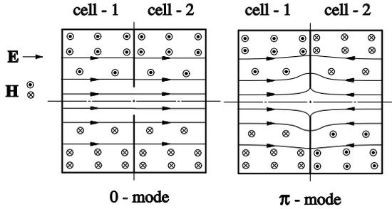
図 3.2 セル結合空洞の 0 および  $\pi$  モード
