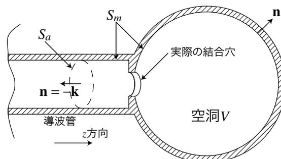
図 4.1 導波管と結合した空洞
