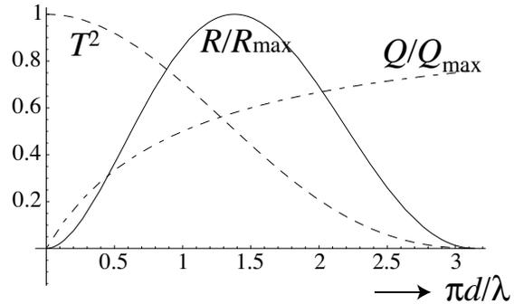
図 2.3 シャント・インピーダンスのピルボックス空洞長依存性
