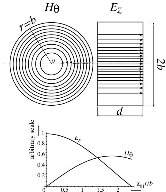
図 2.1 ピルボックス空洞および  $E_z$ 、 $H_\theta$  の動径 ( $r$ ) 依存性
