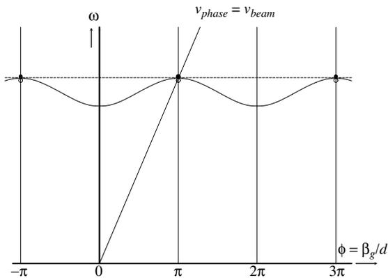
図 3.10  $\varphi_a \rightarrow \pi$  の場合の全空間高調波成分を含めた分散曲線
