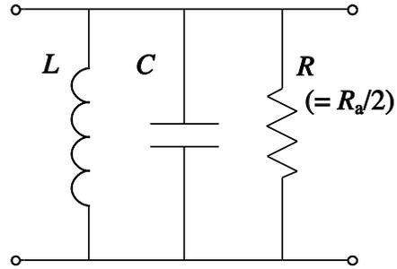
図 2.2 空洞共振の並列共振回路による表現
