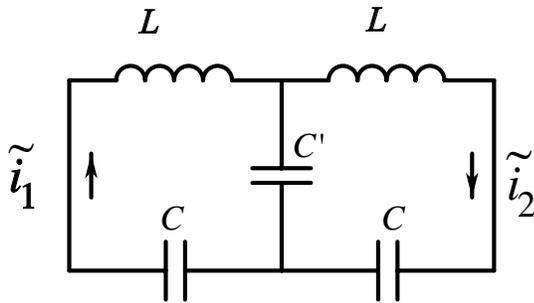
図 3.3 2 セル結合空洞の等価回路
