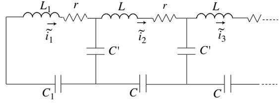
図 3.13 壁損を表す抵抗  $r$  を図 3.11 に追加した回路図
