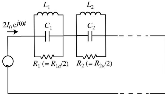
図 5.2 外部ビームですべてのモードが励振されている空洞の等価回路
