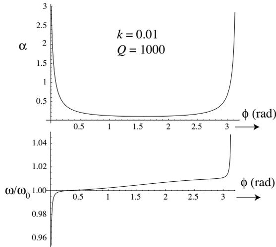
図 3.7 壁損がある無限周期構造の分散曲線
