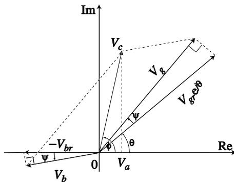
図 5.6 合成空洞電圧のフェーザー図。  $V_c$  は電圧振幅。  $V_a$  はビーム加速電圧。
