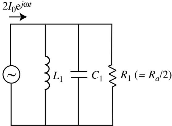
図 5.1 外部ビームで基本加速モードが励振される空洞の等価回路
