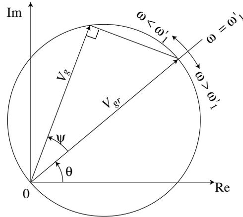
図 5.5 外部電力源がつくる空洞電圧  $\tilde{V}_g$  のベクトル図。  $\psi$  は空洞の同調角。  $\theta$  は入力波の空洞入口における位相。  $\omega$  は入力波の角周波数。
