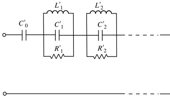
図 4.3 結合孔  $S_a$  (図 4.1、図 4.2) から  $\pm 1/4$  管内波長だけ移動した点でみた空洞等価回路
