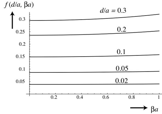
図 2.6 パイプ間容量公式における  $f(x, y)$  項の計算例
