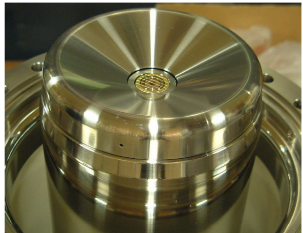
図 1.5 KEK の CNT 陰極電子銃。グリッドの下に黒い CNT の陰極部が見える。
