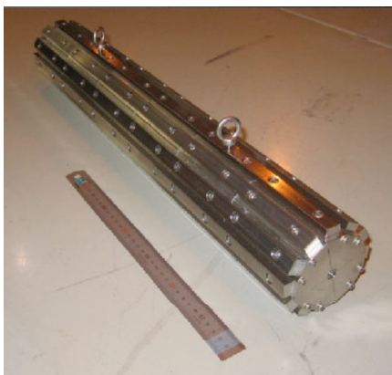
図 16. Halbach 磁極配列を用いた永久四極磁気レンズ。
