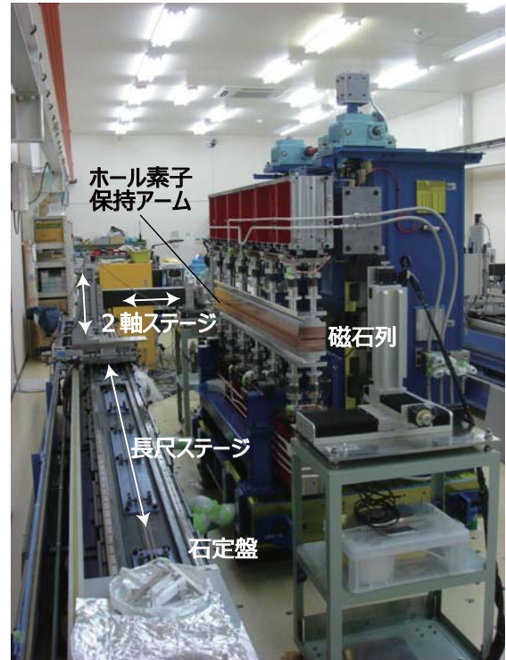
図 15: 高剛性かつ精密な石定盤に基づく従来型磁場測定ベンチ。
