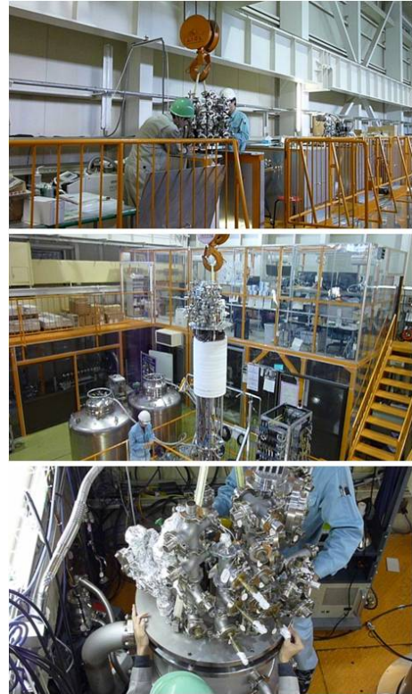
Fig.15 クライオスタットへの空洞の挿入
