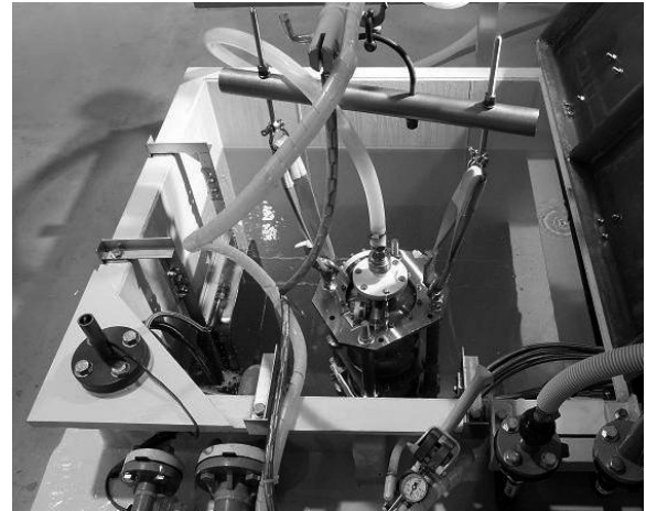
Fig. 10 空洞内の洗剤による超音波洗浄
