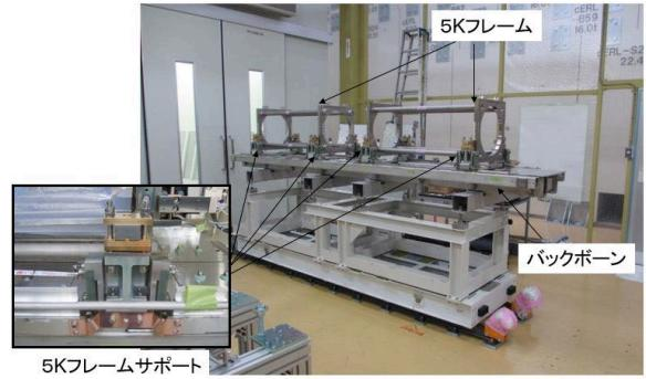
Fig. 97 5K フレームとバックボーンとそれをつなぐ 5K フレームサポート。
