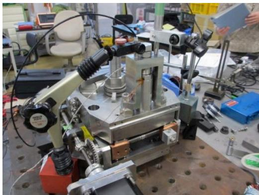
Fig. 91 チューナー試作 1 号機による荷重をかけた時の動作試験の様子。
