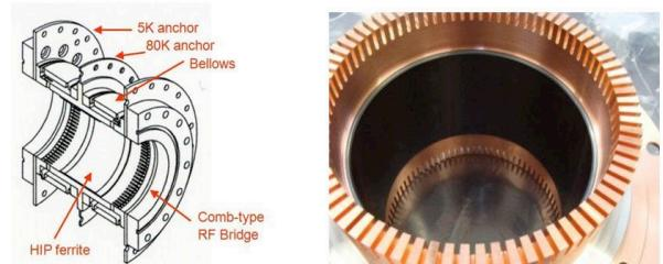
Fig. 79 HOM ダンパー概念図(左)、80K 部の歯に加工された銅に HIP された吸収体(右)
