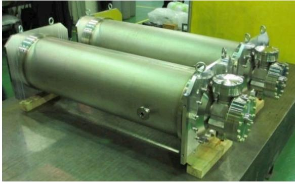
Fig. 96 Ti ジャケットを装着した cERL 用空洞 (KEK-ERL model-2 3号機、4号機)
