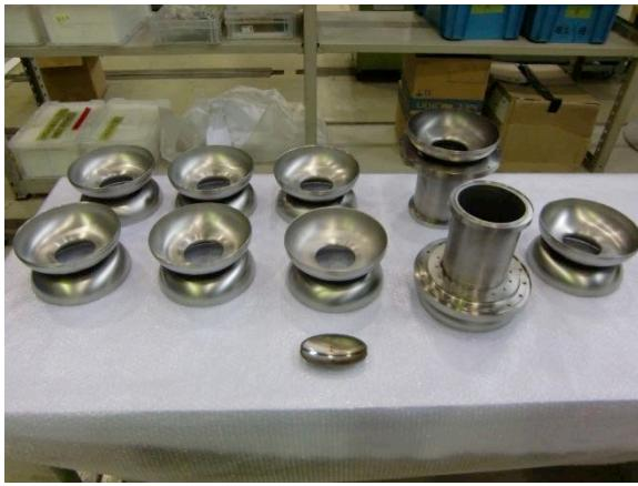
**Fig. 45 KEK-ERL model-2 タイプの Nb 製 9 セル超伝導空洞製作の様子 (3号機)。ダンベルが 7つ (本当は 8つある) と両エンドビームパイプも Nb で作成されている。**
