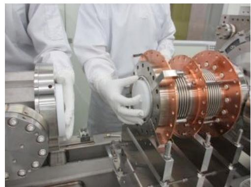
**Fig. 100 空洞と HOM ダンパーとの接続。**
