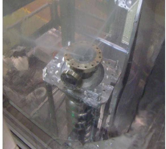
Fig. 50 高圧超純水洗浄(HPR)の様子
