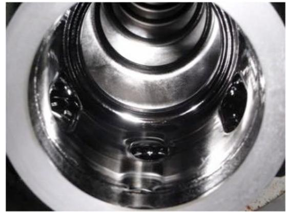
Fig. 49 電解研磨(EP1)後の空洞内面
