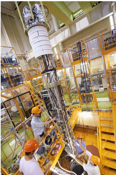
**Fig. 54** クライオスタッフに空洞をいれて縦測定を行う。(KEK-STF)
