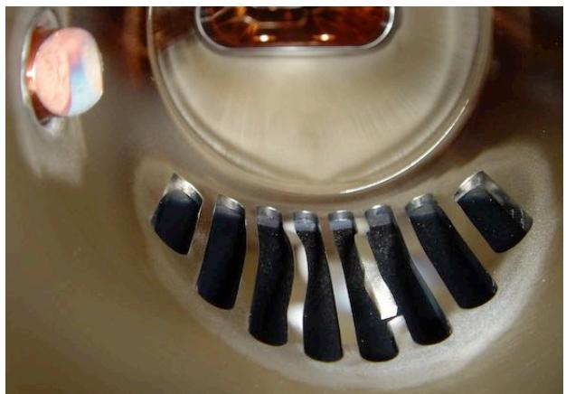
Fig. 7 排気ポートスリットの破損
