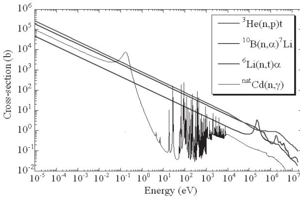
図 4.21:  ${}^{10}\text{B}$ ,  ${}^6\text{Li}$ ,  ${}^3\text{He}$ , Gd の断面積の中性子エネルギー依存性 [11]
