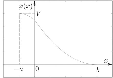
図 4.12: 逆バイアス電圧を掛けた場合の電圧の分布
