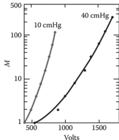
図 4.8: 比例計数管の印加電圧に対するガス増幅率  $M$  [3]
