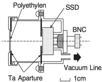
図 4.28: ラジエータ付き半導体検出器テレスコープ [23]
