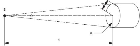
図 4.2: 点線源が円筒型検出器の軸上にある場合
