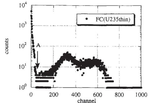
図 4.31: 核分裂計数管の波高スペクトル [23]
