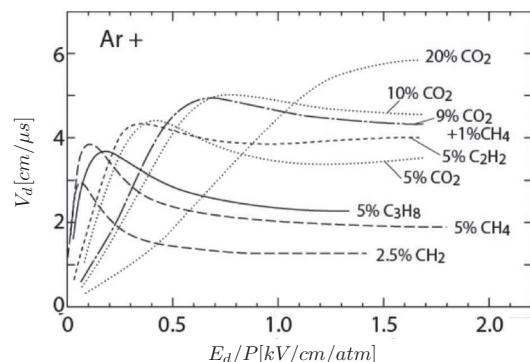
図 4.3: 電子の移動度 [4]
