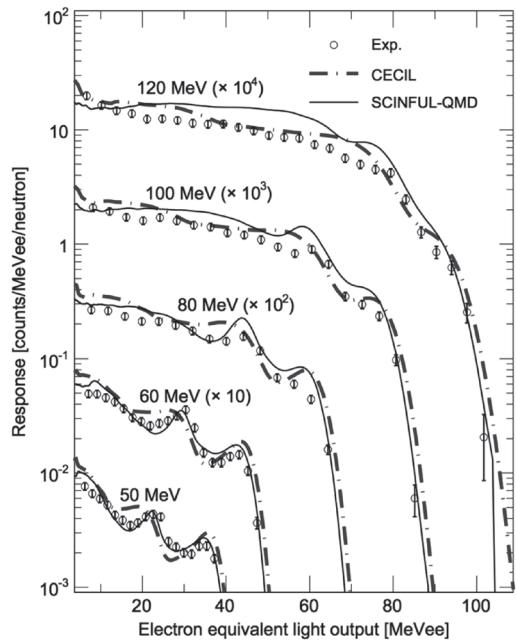
図 4.27: 5 インチ径、5 インチ長の NE213 シンチレータの応答関数 [21]
