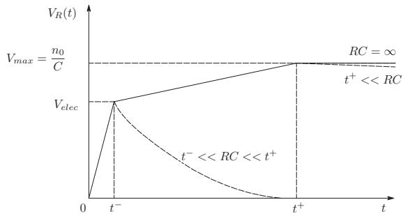
図 4.6: 二極電離箱の出力の経時変化の模式図
