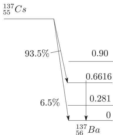
図 2.5:  $^{137}\text{Cs}$  の  $\beta^-$  崩壊後の準位
