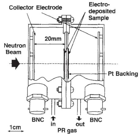
図 4.30: 核分裂計数管 [23]
