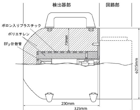
図 4.25: レムカウンタの構造 [4]
