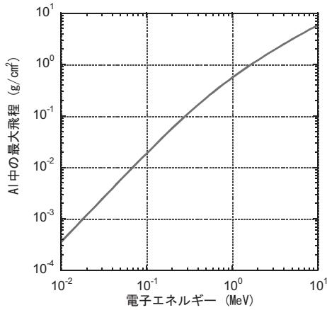
図 3.4: Al 中での電子の最大飛程 [5]
