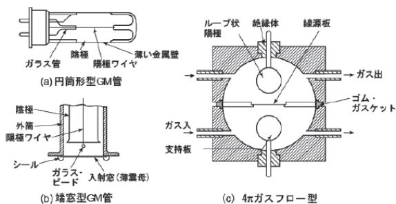
図 4.9: GM 管の構造の例 [6]
