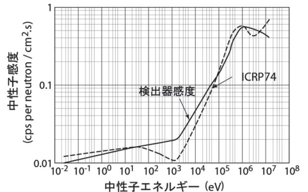
図 4.26: レムカウンタの応答関数 (図中では検出器感度) と 1cm 線量当量換算係数 (ICRP74) の比較 [4]
