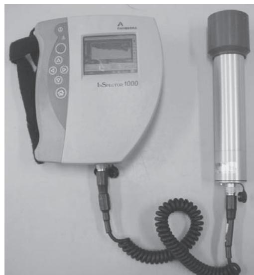
Fig. 4.1  $\text{LaBr}_3$  シンチレーション検出器
