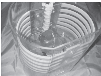
図7 人体胸部の模式図と人体胸部ファントム。縦隔部位はX線の吸収が大きい。
