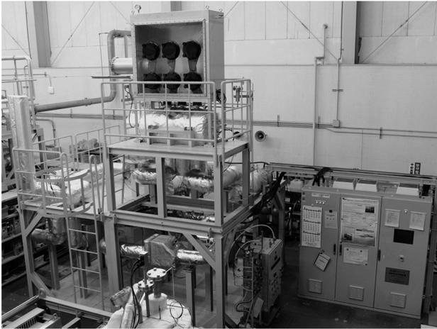
Fig. 12 JAEA の材料腐食試験 LBE ループ
