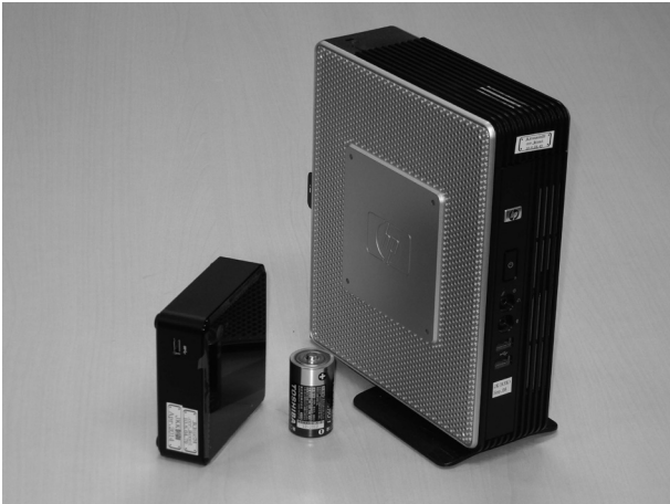
図 18: HP Compaq t5730 (右) と, Intel NUC (左) の外観。中央に置いてあるのはサイズの比較のための単 1 型乾電池。
