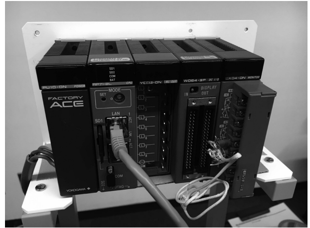
図 15: F3RP71 を用いたシステムの外観。左から順に電源モジュール、F3RP71、3 台の I/O モジュールが実装されている。
