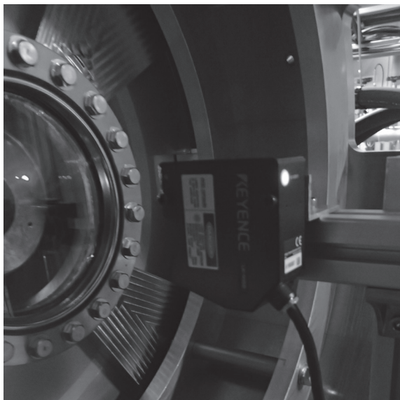
Fig. 28 レーザー変位計 (Keyence, LK-H150) を用いた FC の振動測定の様子。
