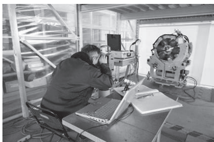
Fig.1.18 左：回転中心の調整の様子、中：磁石に張ったワイヤ、右：回転中心からの電磁石中心のズレ
