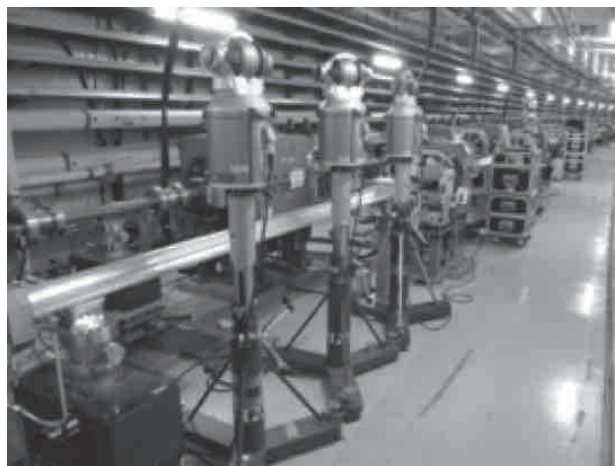
Fig. 2.4 : レーザートラッカー校正の様子
