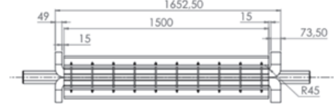
Fig. 1.8 上: BL 電磁石のビーム軸方向の磁場プロファイル、中: フラットトップの拡大図、下: BL 電磁石のボルト位置
