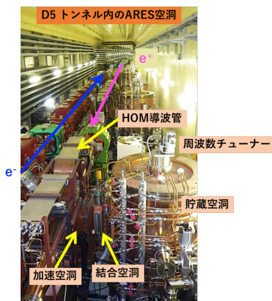
Fig. 14 SuperKEKB トンネル内の ARES 空洞
