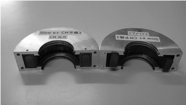
図4 二分割構造によるCM。左半分: コイルを巻いた信号出力部、右半分: テスト入力部。
