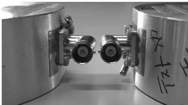
図7 CM 入出力部の拡大図。BNC とケース間にポリイミドフィルムが挿入され、BNC を加速器グランドから絶縁するためのセラミックネジが見えます。
