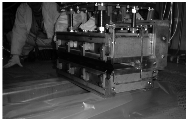
Fig. 1 放射化した KEK-PS ブースターリングの取出セプタム電磁石。
