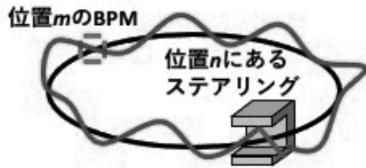
Fig. 3 COD 補正 概念図.
