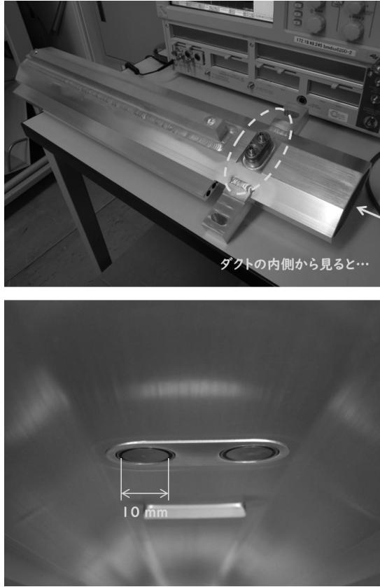
Fig. 12: ボタン型電極の例：PF リング直線部用 4 電極 BPM (ダクト開口：幅 90 mm, 高さ 38 mm の八角形)
