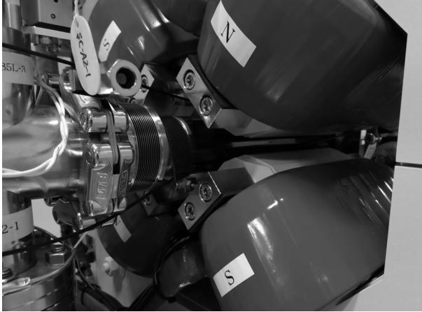
図 39: 四極電磁石中心に張られた光ファイバー
