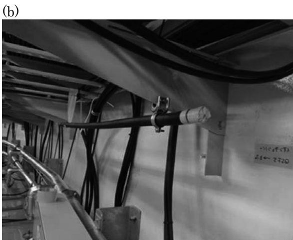
Fig.11 (a)SuperKEKB MR コンクリートシールドの壁に取り付けられたイオンチェンバー及び (b) DR ケーブルラックに取り付けられたイオンチェンバー。
