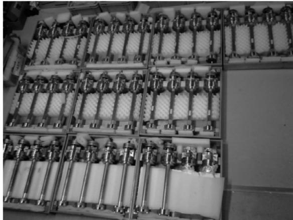
図 34: ATF2 建設時に量産した空洞 BPM
