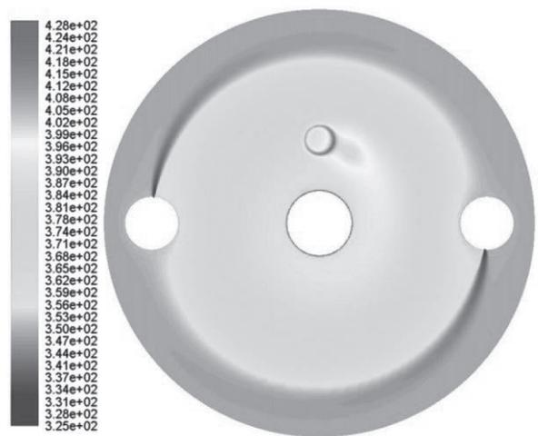
Fig.22 18MW ビーム時の温度分布(K)
