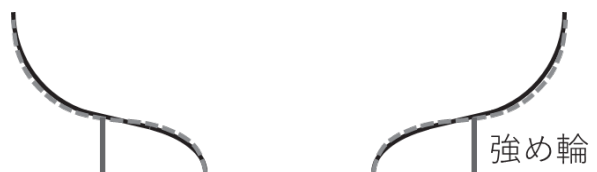
Fig. 38 アイリス溶接後の歪み。実線が溶接前、点線が溶接後のハーフセル形状を示す。
