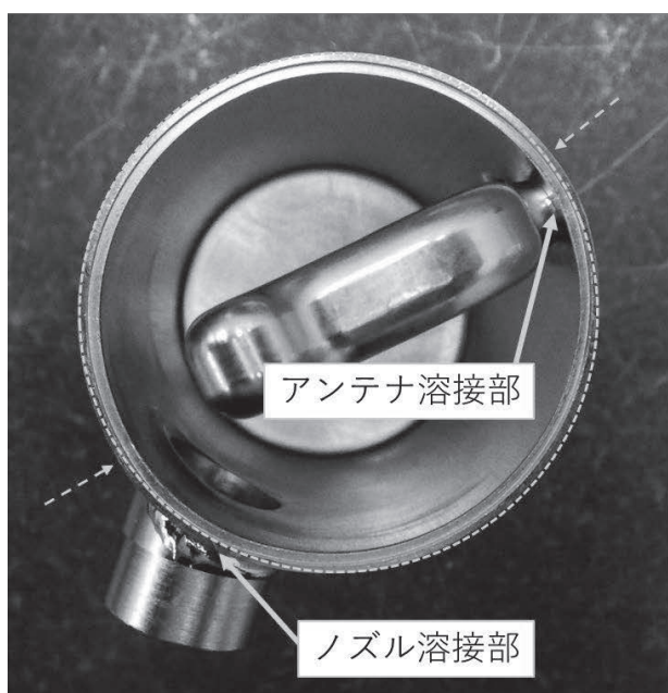
Fig. 26 溶接によって歪んでしまった部品（HOM カプラー）の写真（左）と部品の真円度を測定した結果（右）。左写真で点線円は真円を表す。右写真で青線が実測値。
