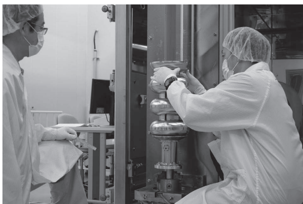
Fig. 39 赤道溶接時の組み立ての様子。
