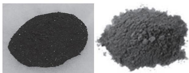
Fig. 21 Nb(II)O(左)とNb(IV)O<sub>2</sub>(右)の写真。文献[25]より。
