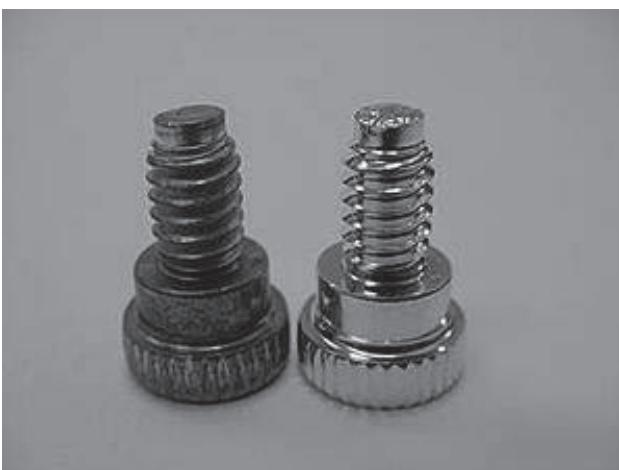
**Fig. 4** EP 处理前(左)、後(右)のネジ。文献[5]より。
