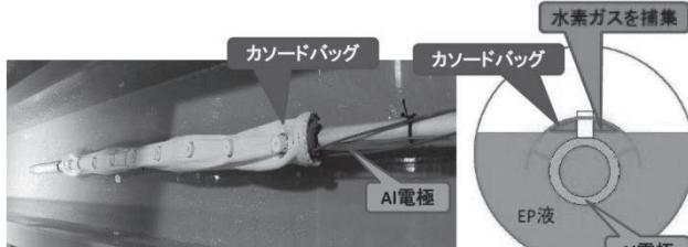
Fig. 11 Nb 空洞処理用の Al カソード。カソードは水素ガスを捕集するテフロン製のカソードバックに覆われている。
