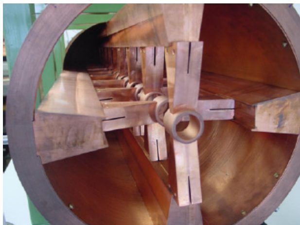
Fig. 50 350MHz CH-DTL モデル
