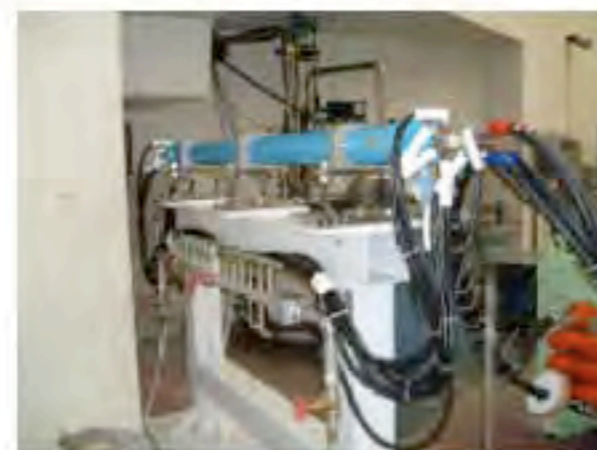
パルス六極電磁石レンズ パルス中性子源に対応可能なパルス電磁石です。
