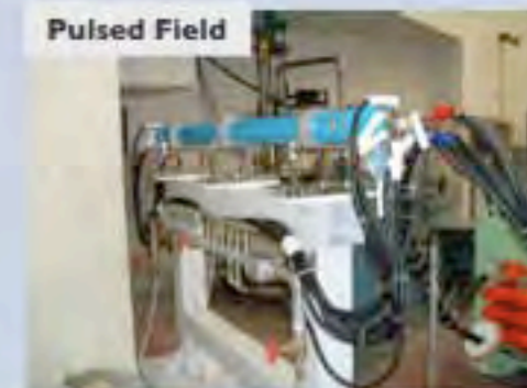
パルス六極電磁石 Magnet Length=2m Aperture=φ22mm
