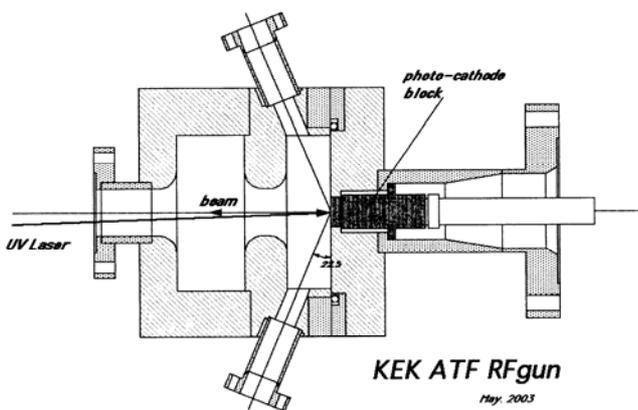
図 1.4 KEK ATF の RF 電子銃。RF 加速空洞の出口側のやや斜め方向からレーザー光を入射する。
