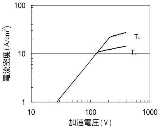
図 4.1 空間電荷制限電流の加速電圧依存性
