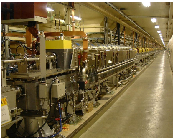
図 18: KEBB ライナック陽電子生成装置
