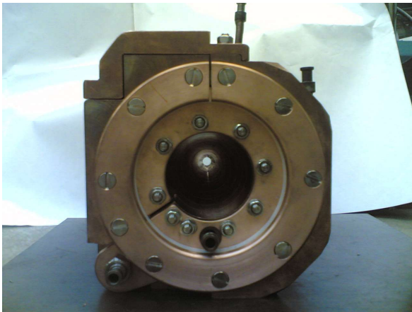
図 25: BINP 型 フラックス・コンセントレータ
