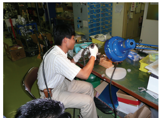
図 2-60 コンタクト付けスポット溶接の様子
