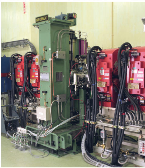
図 1-9 PF の真空封止型短周期アンジュレータ U17
