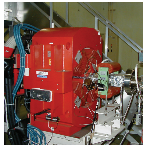
図 2-25 PF リングの 4 極電磁石
