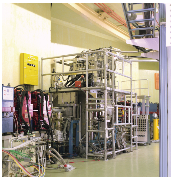
図 1-3 PF の超伝導垂直ウィグラー
