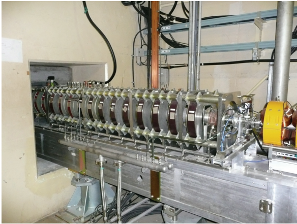
図 2-7 ソレノイドが巻かれた 初段の加速管
