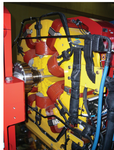
図 2-26 PF リングの 6 極電磁石
