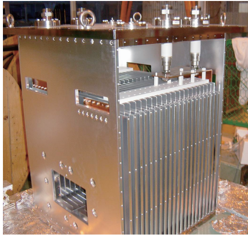
図 6.5: キッカー電磁石の構成。右図は、RCS キッカー電磁石本体。
