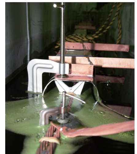
図4 電解研磨模式図及び実際の様子(テストダクト時)。
