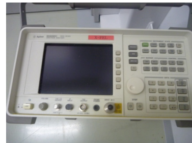
図 A2.2.2 25GHz スペクトラムアナライザ。
