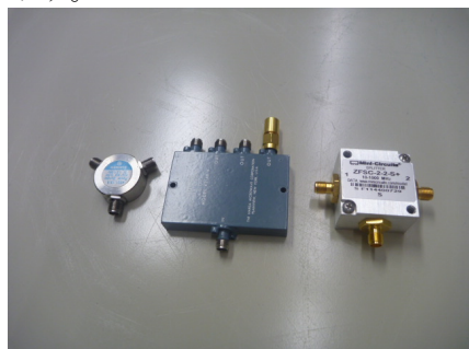
図 A1.5.1 左から抵抗分割型 2 分割ディバイダ、抵抗分割型 4 分岐ディバイダ、ウィルキンソン型ディバイダ。
