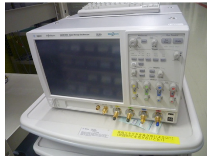
図 A2.1.1 アナログ帯域 12GHz のオシロスコープ。
