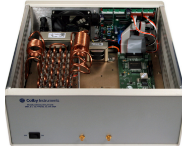
図 2.6.3 デイレイラインの例。出典 http://colbyinstruments.com 。
