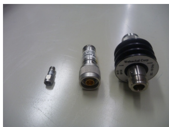
図 A1.4.1 固定アッテネータ。左から SMA アッテネータ、N 型アッテネータ、N 型 20W アッテネータ。
