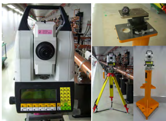
図 3-4. トータルステーション。左： TEA5005 。右上：ターゲット(SMR)。右下：木製三脚と鋼製架台
