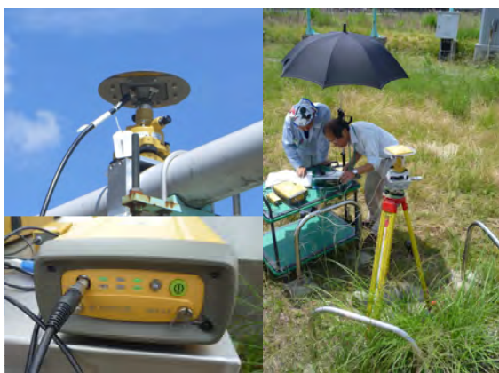
図 3-5. GNSS 測量器、NeT-G3。左上：アンテナ。左下：受信機。右：計測風景。
