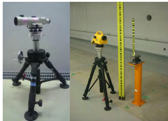
Fig. 3-1 オートレベル。左：AS-2(オプティカルマイクロメータ付き)。右：デジタルレベル DiNi0.3 と標尺
