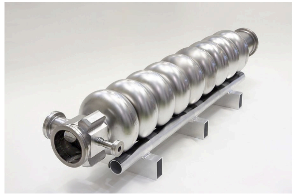
Fig. 44 KEK-ERL model-2 タイプのNb製9セル超伝導空洞(1号機)。
