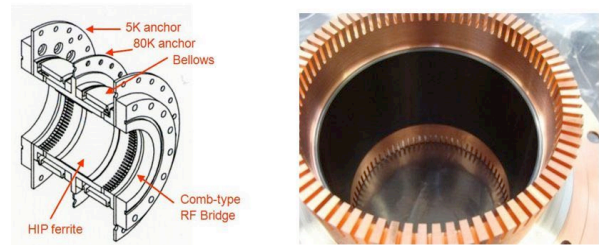
Fig. 79 HOM ダンパー概念図(左)、80K 部の櫛歯に加工された銅に HIP された吸収体(右)
