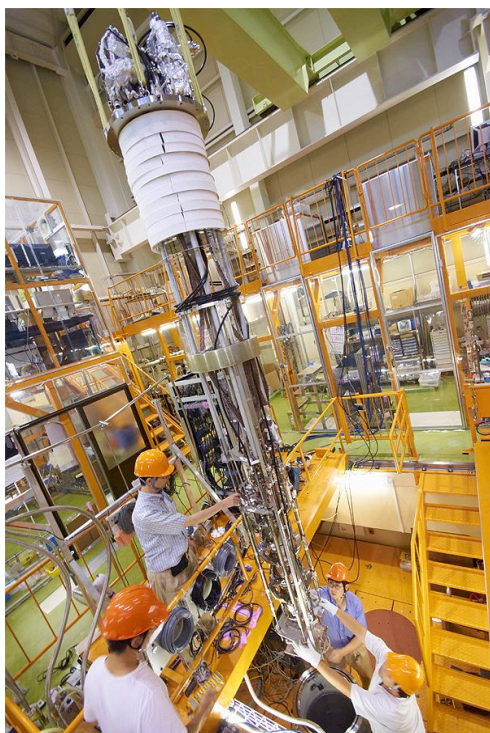
Fig. 54 クライオスタットに空洞をいれて縦測定を行う。(KEK-STF)
