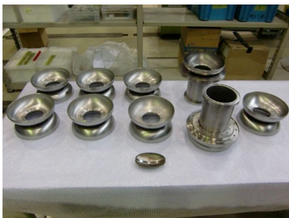
Fig. 45 KEK-ERL model-2 タイプのNb製9セル超伝導空洞製作の様子(3号機)。ダンベルが7つ(本当は8つある)と両エンドビームパイプもNbで作成されている。
