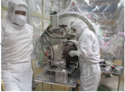
Fig. 102 クリーンルーム内の空洞接続作業後のcERL主加速器クライオモジュールアセンブリ作業。
