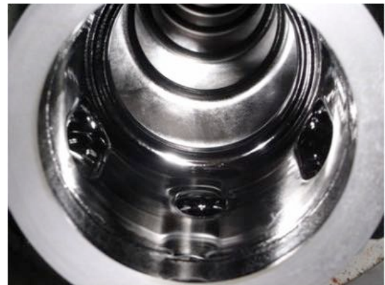
Fig. 49 電解研磨(EP1)後の空洞内面
