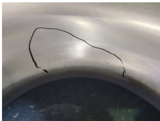
Fig. 46 製作上の内面のすり傷。この部分はその後、バフ研磨によって滑らかにした。
