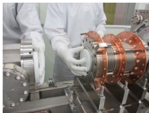
Fig. 100 空洞と HOM ダンパーとの接続。
