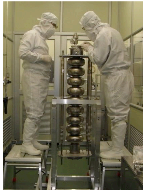
Fig. 53 class 10 クリーンルーム内空洞アセンブリ作業。(1号機)
