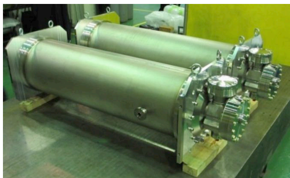
Fig. 96 Ti ジャケットを装着した cERL 用空洞 (KEK-ERL model-2 3 号機、4 号機)
