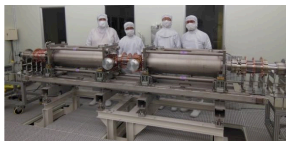
Fig. 101 class 10 のクリーンルーム内での空洞接続完了。
