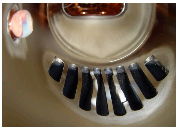
Fig. 7 排気ポートスリットの破損
