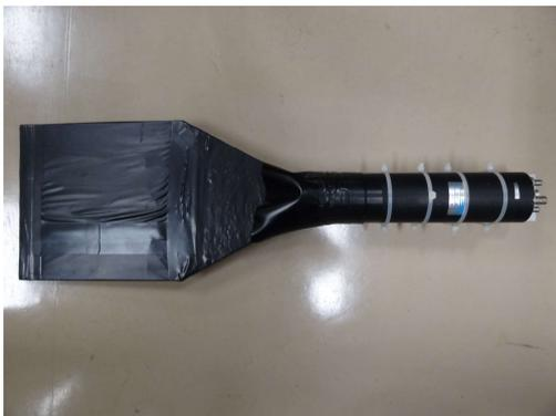
Fig. 13 シンチレーションカウンター
