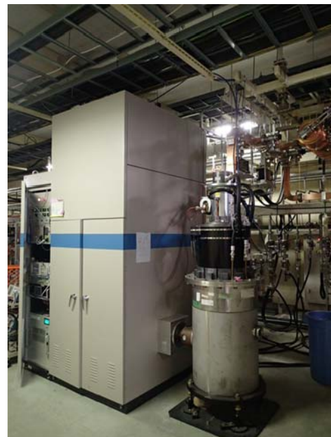
図 4 KEKB LINAC 大電力 RF ユニット。
