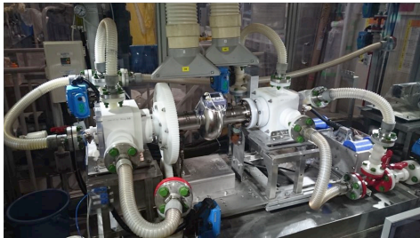
図 18: 電解研磨装置の模式図と STF 電解研磨装置の写真。
