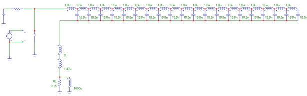
Fig. 17 PFN シミュレーション回路
