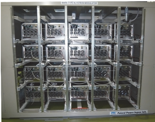
Fig. 45 チョップパ型 Marx 電源の写真
