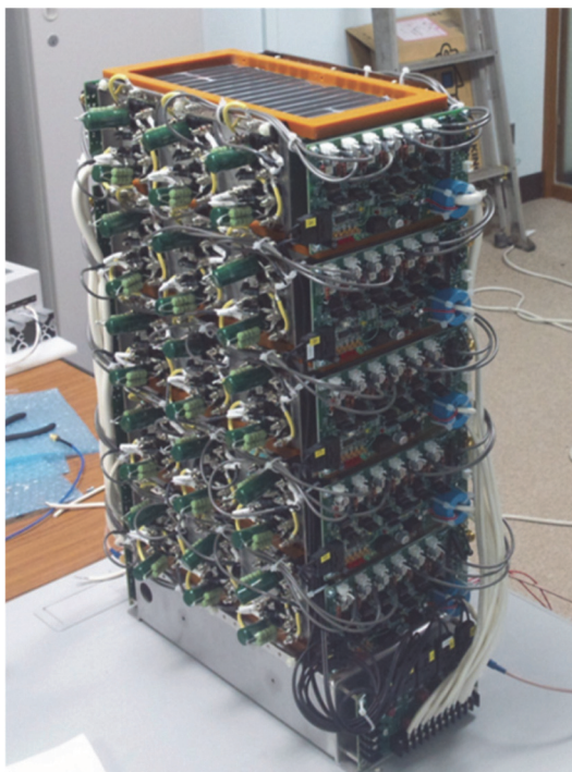
Fig. 21 SI サイリスタを使用したサイラトロン代替半導体スイッチ (参考文献[8]より引用)
