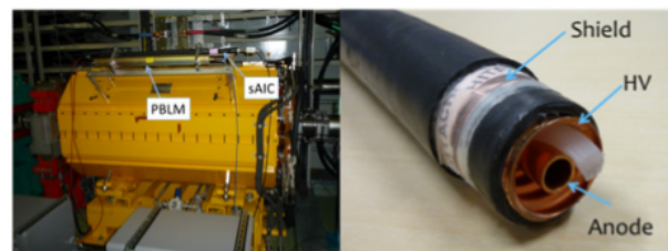
Fig. 55 MR で使用されているビームロスモニター [35]
