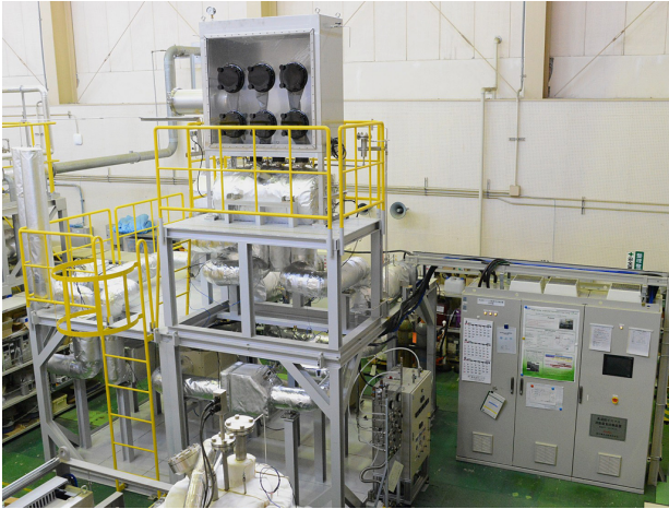
Fig. 12 JAEA の材料腐食試験 LBE ループ OLLOCHI
