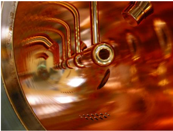
Fig. 16 J-PARC SDTL 内部
