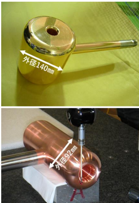
Fig. 18 ドリフトチューブ。上：DTL 用、下：SDTL 用。
