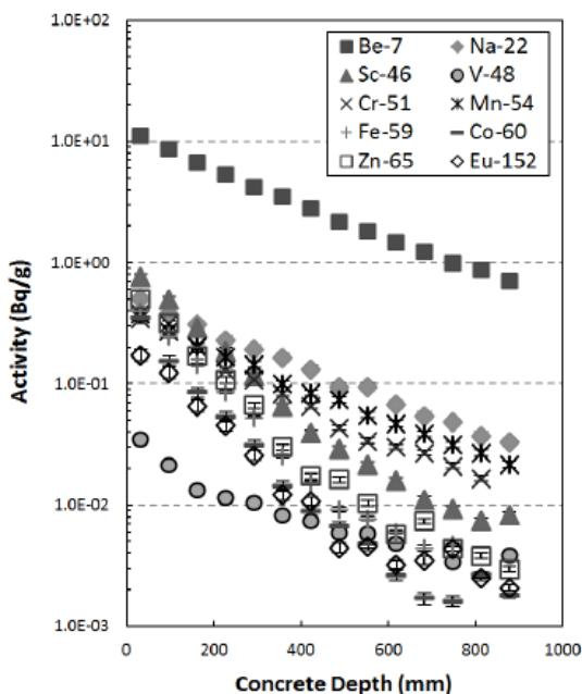
図4.7-1 MR入射点付近コンクリートにおける生成核種濃度の深度分布
