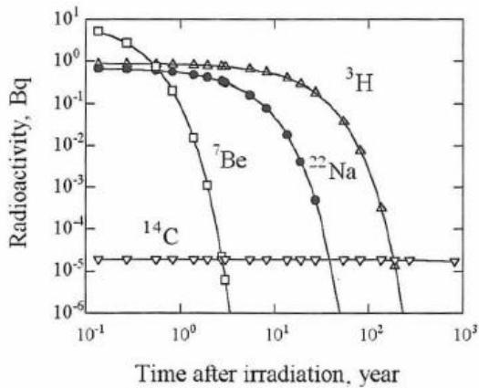
図 9 アルミニウム中に生成する核種の時間変化[10]
