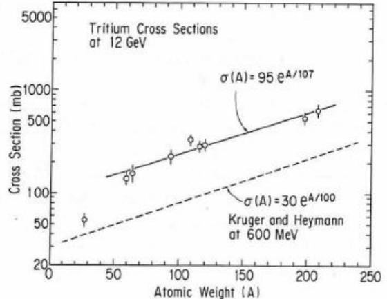
図 7 標的の質量数に対するトリチウムの生成断面積[9]
