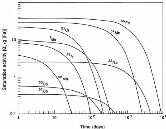
図3 KEK-PS の遅い取り出しラインで照射した鉄中の放射能の時間変化[6]
