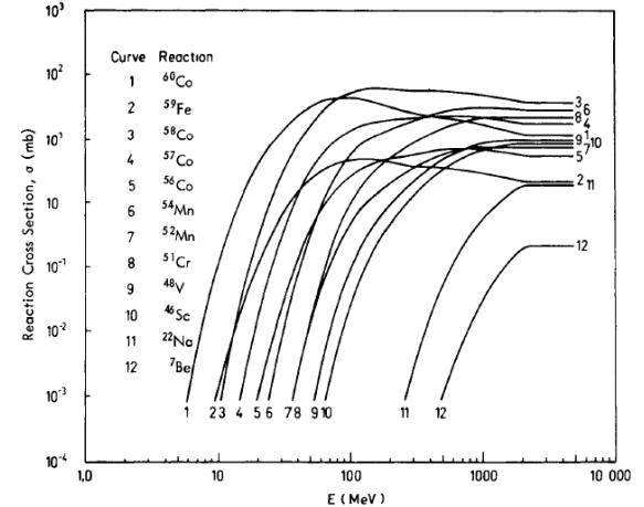
図2 中性子エネルギーに対する銅から生成する核種の断面積[4,5]
