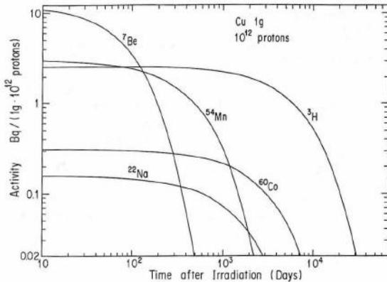
図 8  $10^{12}$  個の陽子(12GeV)が入射した場合に銅 1g 中に生成する核種の時間変化[9]
