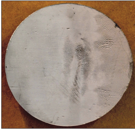
Fig. 6-7 米国 SNS の水銀標的容器のビーム窓 (狭隘流路外側壁) の観察結果[34]
