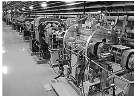
Fig. 77 LER アーク部に新設された垂直型ビームコリメーター。
