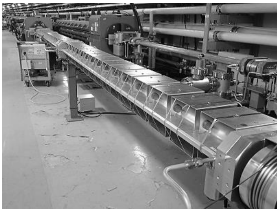
Fig. 63 LER ドリフト部ビームパイプに並べられた ECE 対策用永久磁石ユニット。
