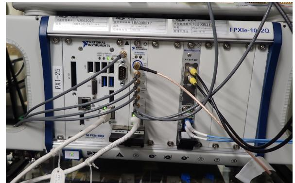
Fig. 23 NI PXI-6683 を用いた PTP 時刻配信 及びタイミング記録システム。
