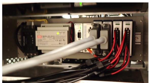
Fig. 20 compactRIO を用いたインターロックシステムの外観。
